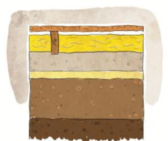
Koolattu puulattia (riskialtis rakenne)
