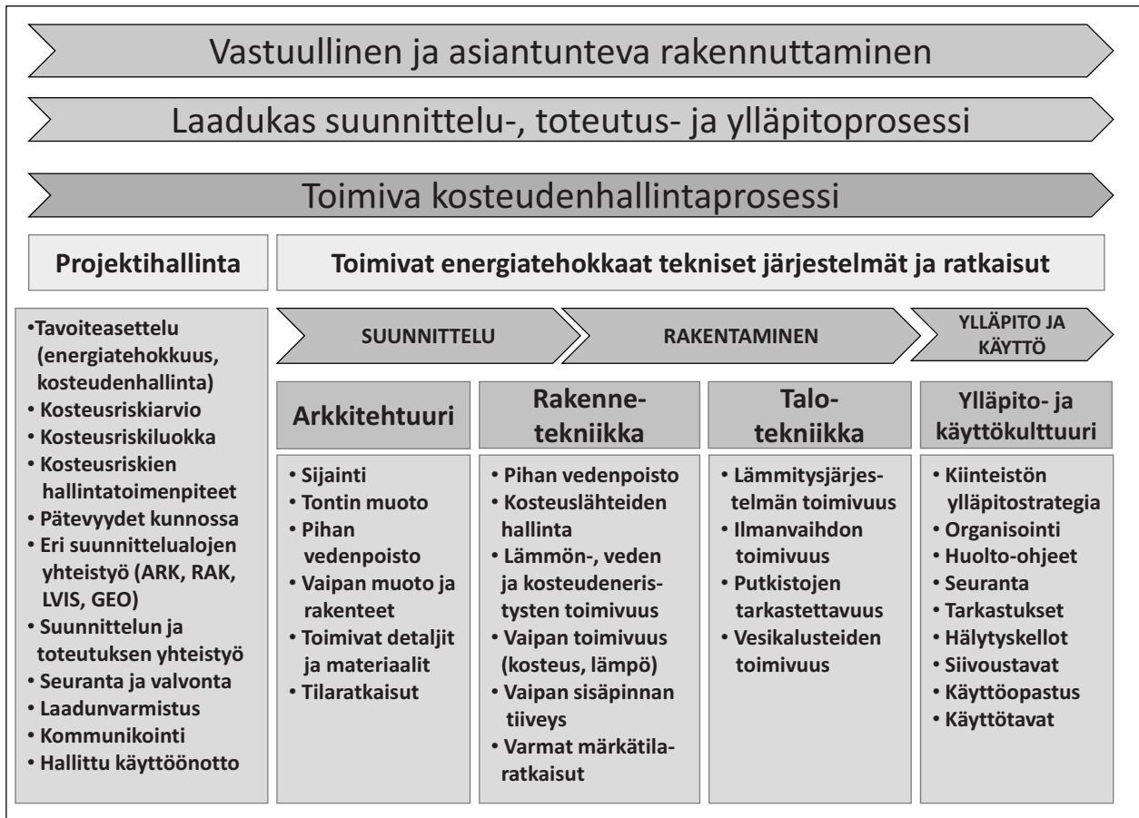
Kuva 1. Kosteudenhallinnan pääkohdat [RIL 250- 2011. Kosteudenhallinta ja homevaurioiden estäminen]
