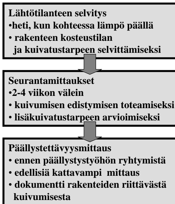
Kuva 5.4. Rakennekosteusmittausten kulku. Mittauksilla seurataan rakenteiden kuivumista ja varmistetaan riittävä kuivuminen.
