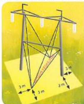
Harustettu, kaksijalkainen pylväs
