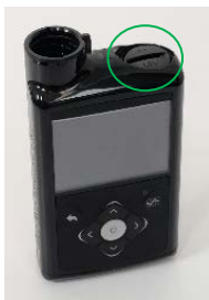
Paristolokeron kansi sijaitsee AA-paristolokero päällä pumpun yläosassa.
