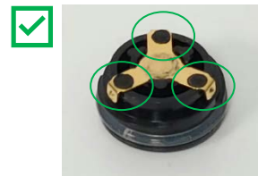
Vahingoittumaton paristolokeron kansi - käyttöä voi jatkaa. Kannessa on kolme kohotettua, pyöreää, mustaa pistettä, jotka pitävät metallikoskettimen paikallaan.
