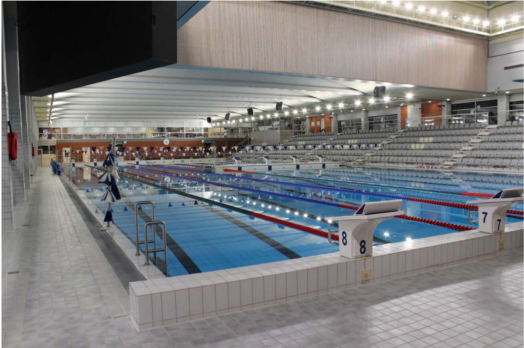
64. Nykyinen väri- ja materiaalimaalima on monimuotoinen. Lattioissa valkoinen nappulalaatta on vaihdettu vaaleansiniseen himmeään laattaan. Betonipilarit on laatoitettu ja seinäelementtien betoni on maalattu harmaalla tai vaaleankeltaisella. Puurimoitus on käsitelty alkuperäistä vaaleammalla kuultovärillä. Ikkunoissa on vaaleankeltaiset pimennysverhot.
