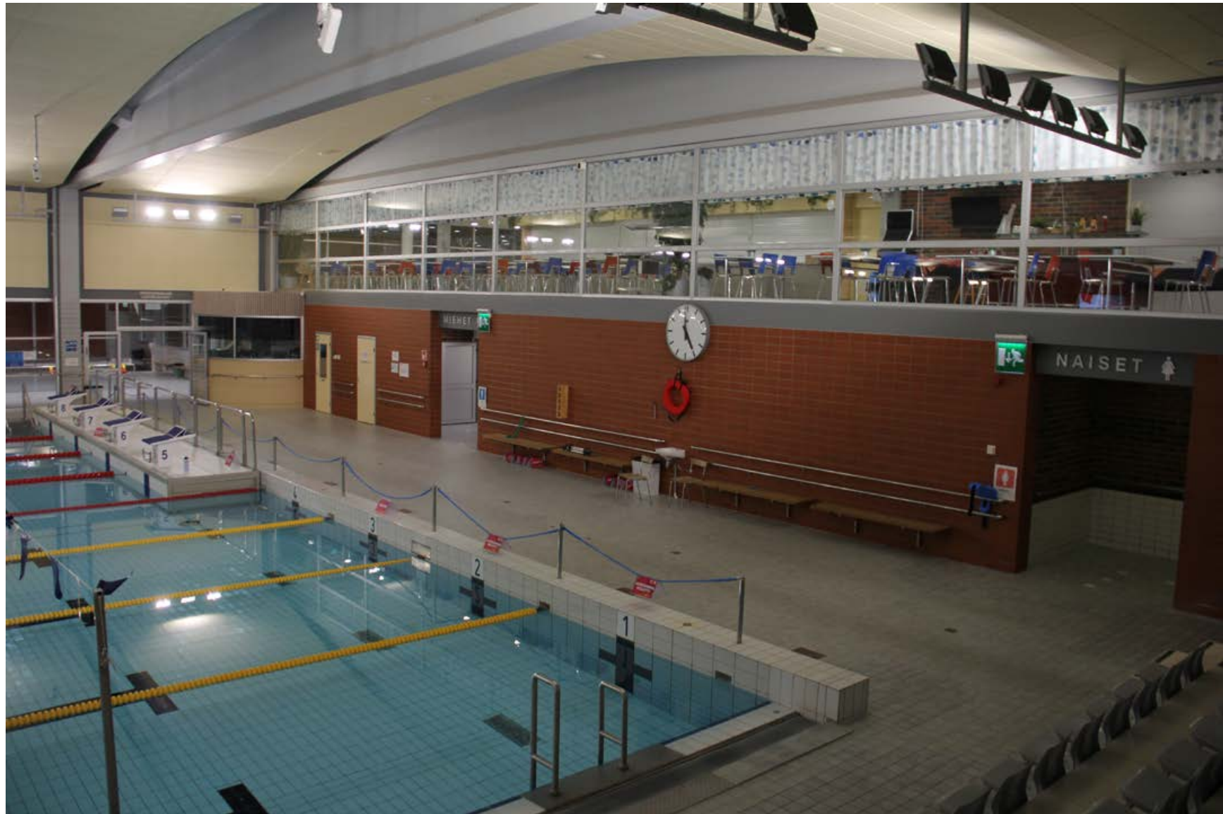
72. Pääaltaan nykyinen värimaailma ja muotokieli ovat muuttuneet. Tiili- ja betonipintoja on maalattu tai laatoitettu. Suurin muutos on alakaton avaaminen ja palkkien välien tekeminen kaareviksi. Päätyseinän reikätiili ja pilarit on laatoitettu peittoon. Päätyseinälle on tehty kiinteät istuimet. Teräskaitteita on poistettu. Valaistus on siirretty altaan yläpuolelta reunoille ja toteutuu epäsuorana sisäkaton kautta.
