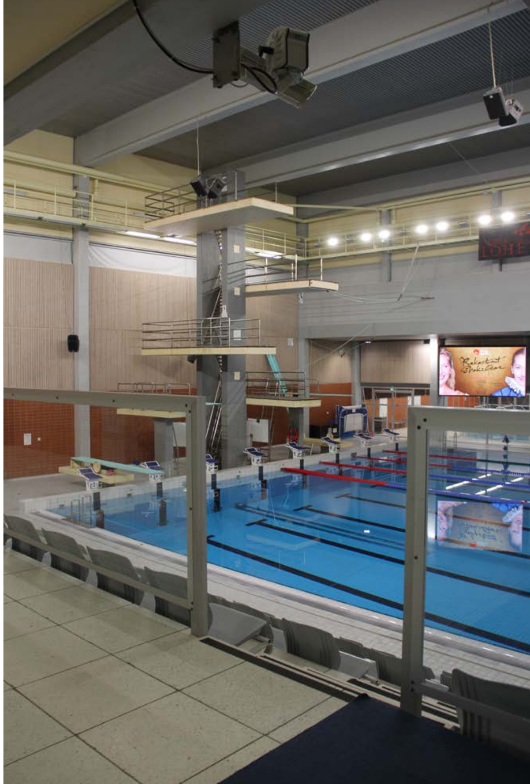
78. Vastaava näkymä vuodelta 2019. Betonipinnat on maalattu harmaalla tai vaalean keltaisella. Ikkunat on peitetty vaaleankeltaisilla pimennysverhoilla. Takaseinän tiili on vaihdettu tiililaattaan ja sen yläpuolinen rimoitus on saanut alkuperäistä vaaleamman sävyn. Lähtötelineet on uusittu.
