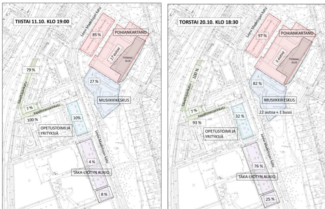
Kuvat 7 ja 8. Tiistai-illan ja torstai-illan suunnittelualueen ja lähialueen pysäköintialueiden käyttöasteet.
