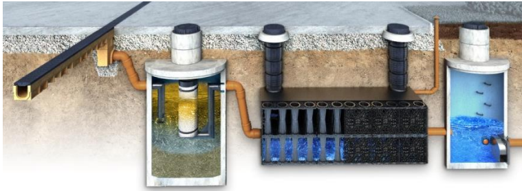
Kuva 14 Hulevesikasettijärjestelmä hulevesien imeytykseen/viivytykseen (ACO Nordic Oy) kuvassa vasemmalta – oikealle: linjakaivo – erotuskaivo – viivytyskasetti – virtausääntökaivo
