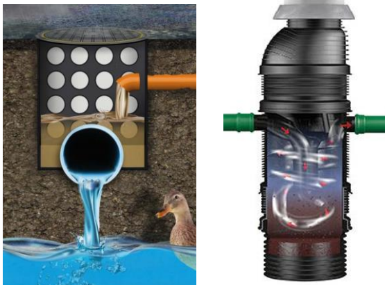
Kuva 15 Smart Trap –hulevesikaivo vasemmalla ja EuroHEK Filter –kiintoaine-erotin oikealla ( www.uponor.fi ja www.wavin.com ).
