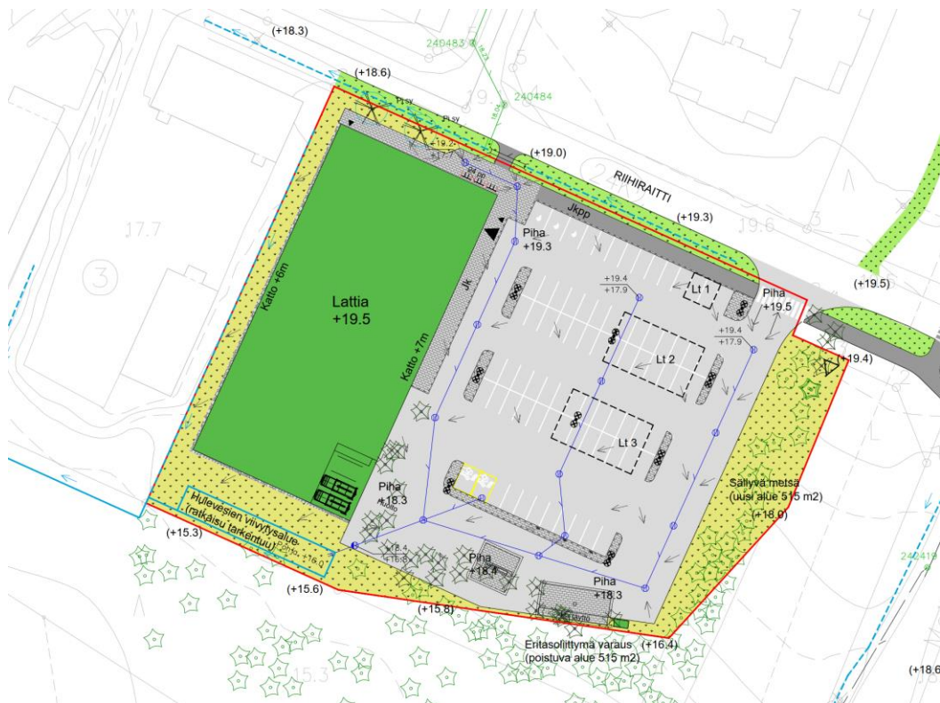
Kuva 10 Ote alustavasta hulevesien hallintasuunnitelmasta tontilla (A-insinöörit 13.11.2025).
