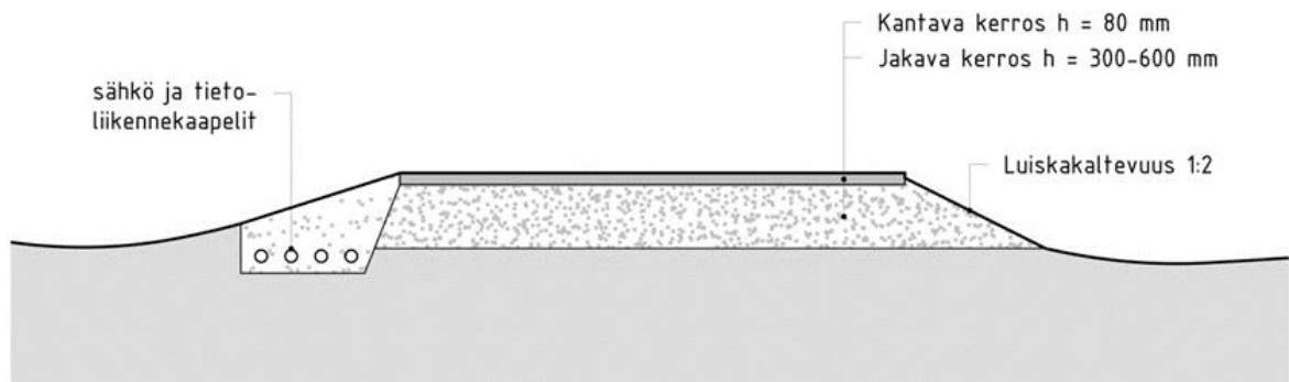
Periaatekuva uuden ja perusparannettavan tien rakenteesta.
