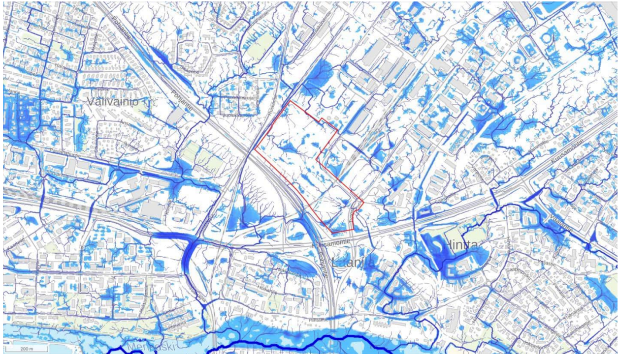
Kuva 14 Hulevesien selvitysalueen (punainen viiva) lähiympäristön tulvareitit tulvareittiaineiston pohjalta. Mallinnuksessa ei ole huomioitu hulevesiviemäreitä eikä kaikkia rumputietoja. (Kuva: FCG, 20.1.2025)
