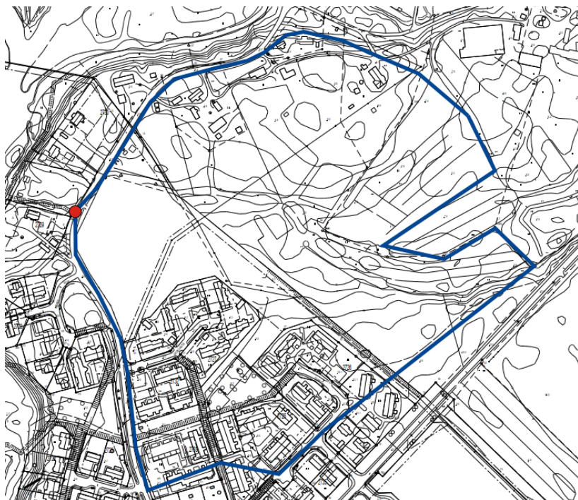
Kuva 4. Myllysaarentien ojan arvioitu valuma-alue. Myllysaarentien alittava rumpu merkattu punaisella pisteellä.
