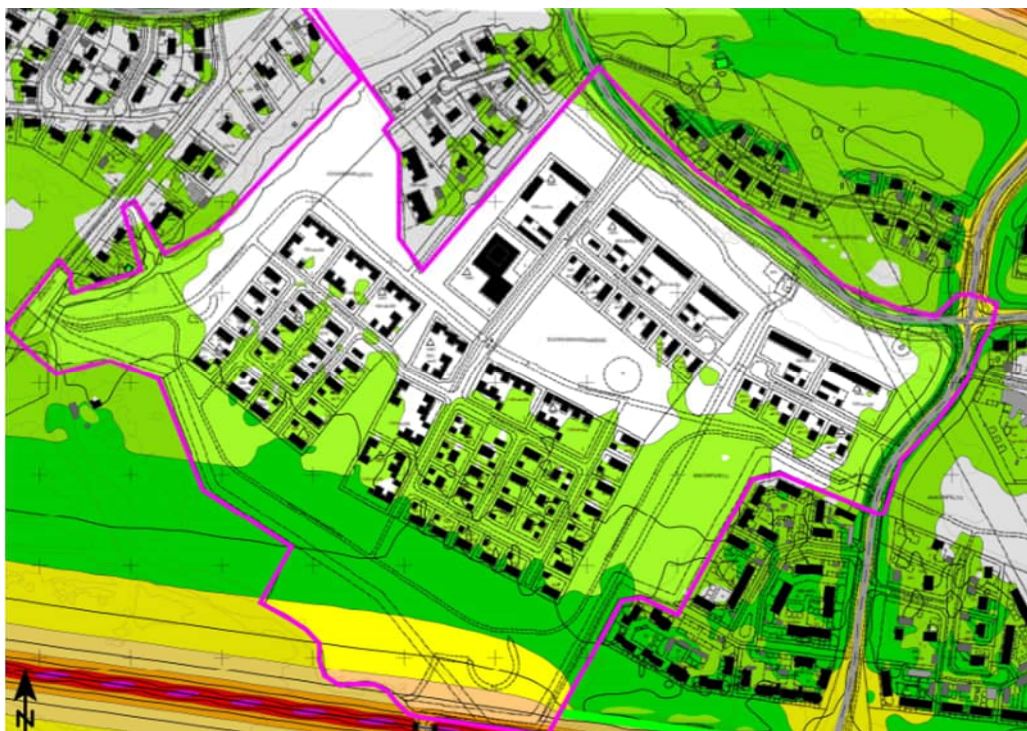
Kuva 9. Rakennusmassat käännetty. Keskiäänitasot ennustetilanteessa yöai- kaan.
