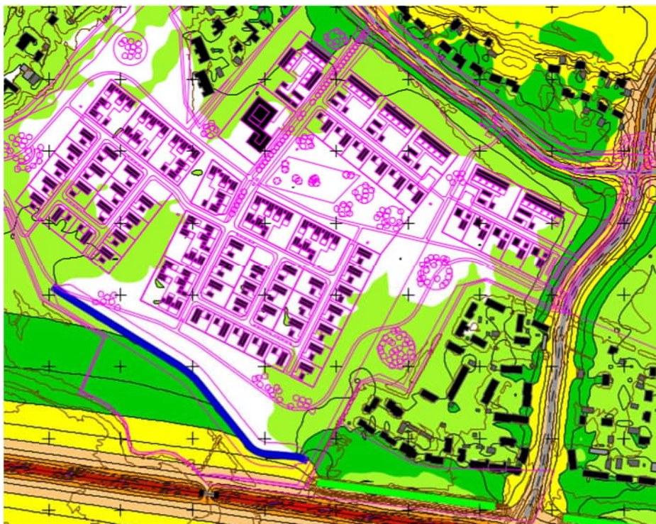
Kuva 15. Sinisellä viivalla esitetty laskennoissa huomioitu 3 metriä korkea meluntorjunta ennustetilanteessa yöaikaan.
