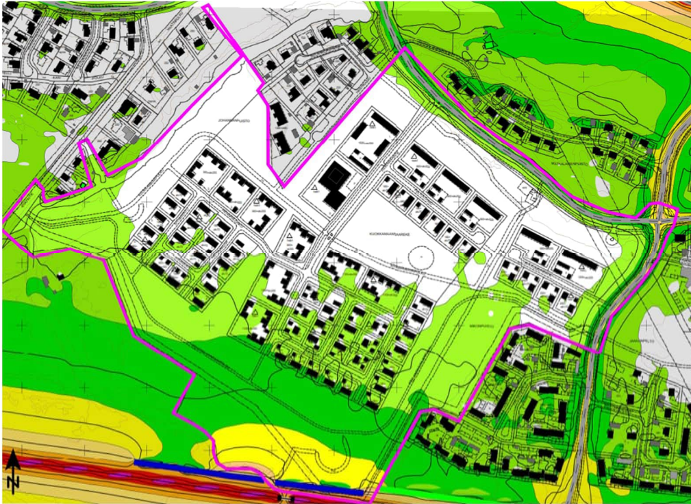
Kuva 11. Sinisellä viivalla esitetty laskennoissa huomioitu 4 metriä korkea meluntorjunta ennustetilanteessa yöaikaan.
