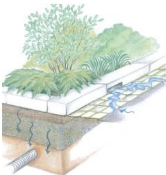
Kuva 5.4. Esimerkkikuva salaojitetusta biosuodatusrakenteesta.
