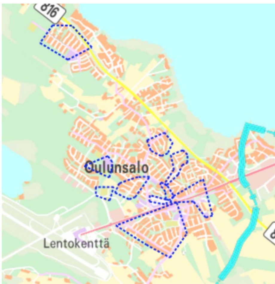
Kuva 44. Alueet, joilla on vanhempia hulevesiputkia (rakennettu ennen 2010).
