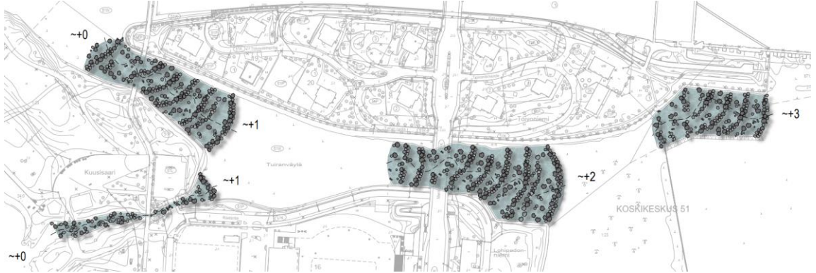
Kuva 12. Tuiraväylään esitetyt koskirakenteet.
