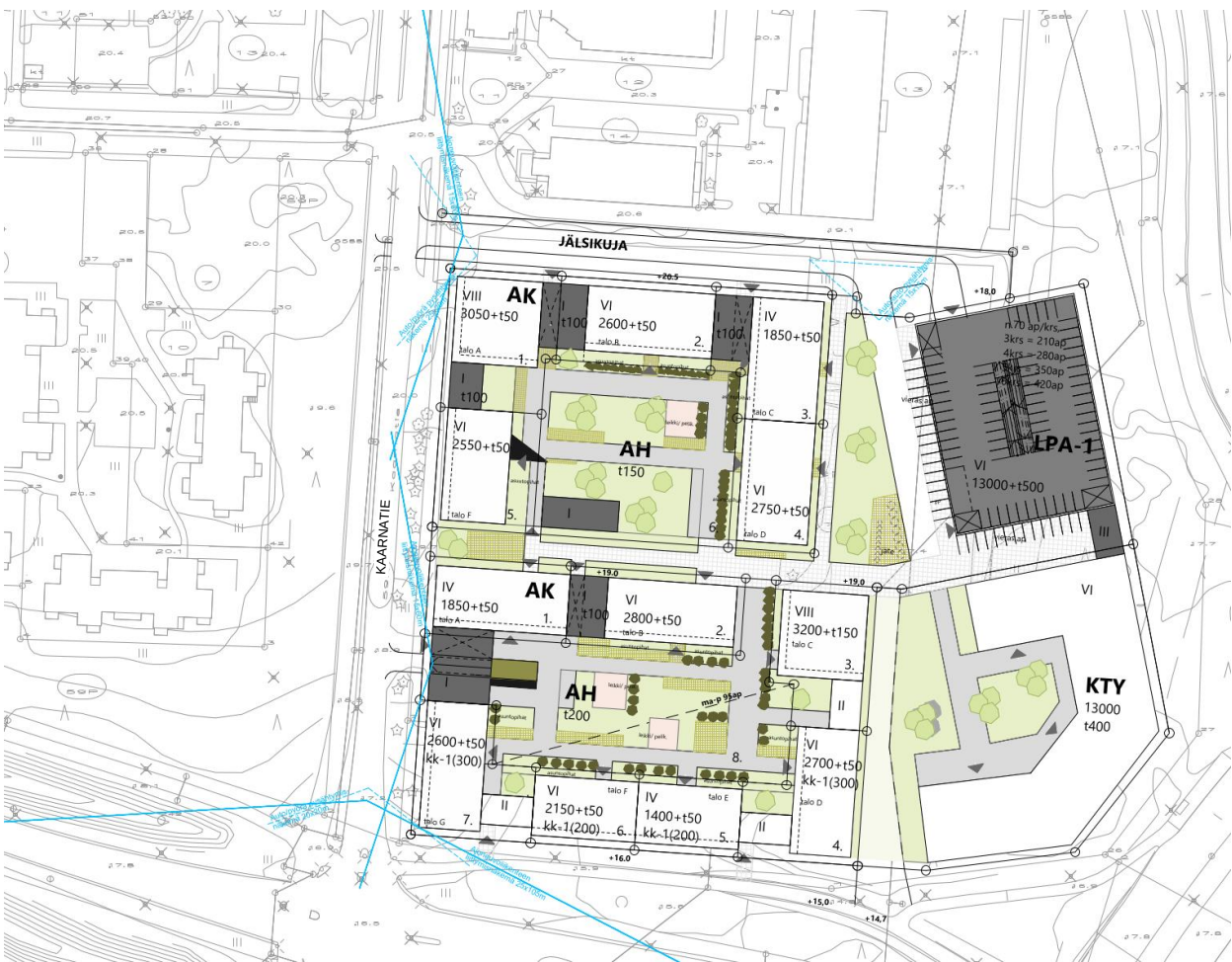
Kuva 3 Alueen viitesuunnitelma (Uki Arkkitehdit) ja näkemäkolmiot (A-insinöörit), kuvan korttelialueilla on virheelliset merkinnät AK, AH ja LPA-1, merkinnät pitäisi olla AL, AH-1 ja LPA-3
