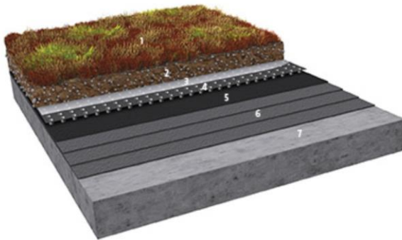
Kuva 16. Viherkaton rakenteet. Kuva: Leca Finland Oy.
