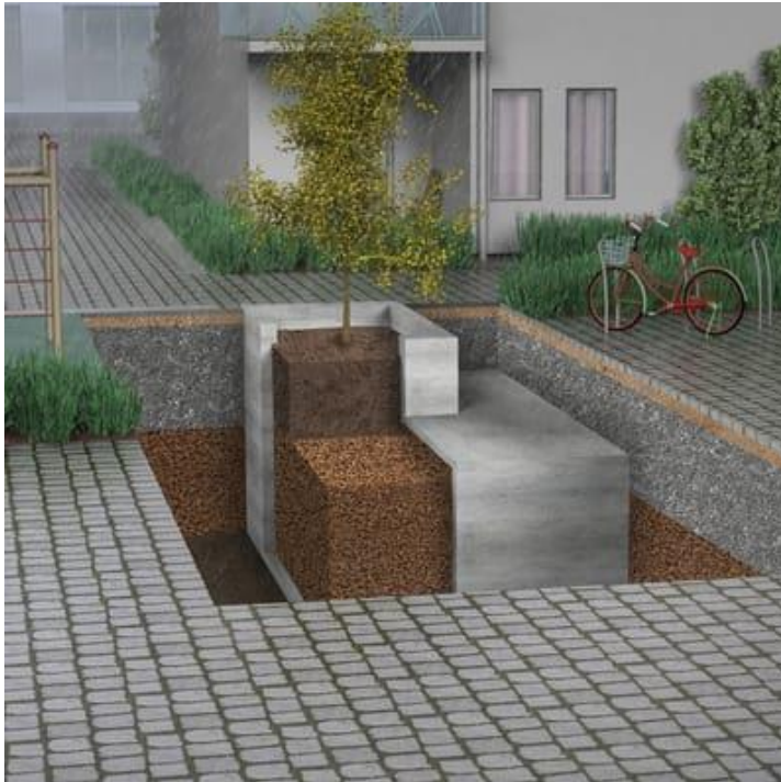
Kuva 6 Leca-sora täytöllä toteutettu biosuodatus ja viivytys rakenne istutuslaatikossa ( www.leca.fi )
