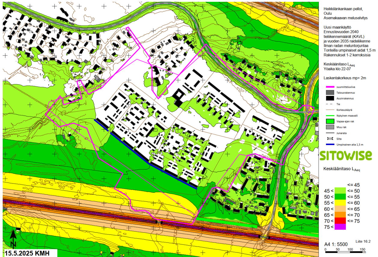
Kuva 9 Melumallinnos ennustetilanteessa yöaikaan (Sitowise Oy 2025). Alueen eteläreunalle on mallinnettu kaksikerroksiset asuinrakennukset ja 1,5 m:n korkuinen aita.
