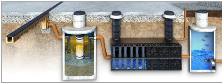
Kuva 14 Hulevesikasettijärjestelmä hulevesien imeytykseen/viivytykseen (ACO Nordic Oy) kuvassa vasemmalta – oikealle: linjakaivo – erotuskaivo – viivytyskasetti – virtauksensäätkä
