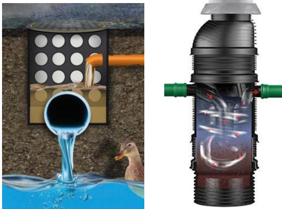
Kuva 1 Smart Trap –hulevesikaivo vasemmalla ja EuroHEK Filter –kiintoaine-erotin oikealla ( www.uponor.fi ja www.wavin.com ).
