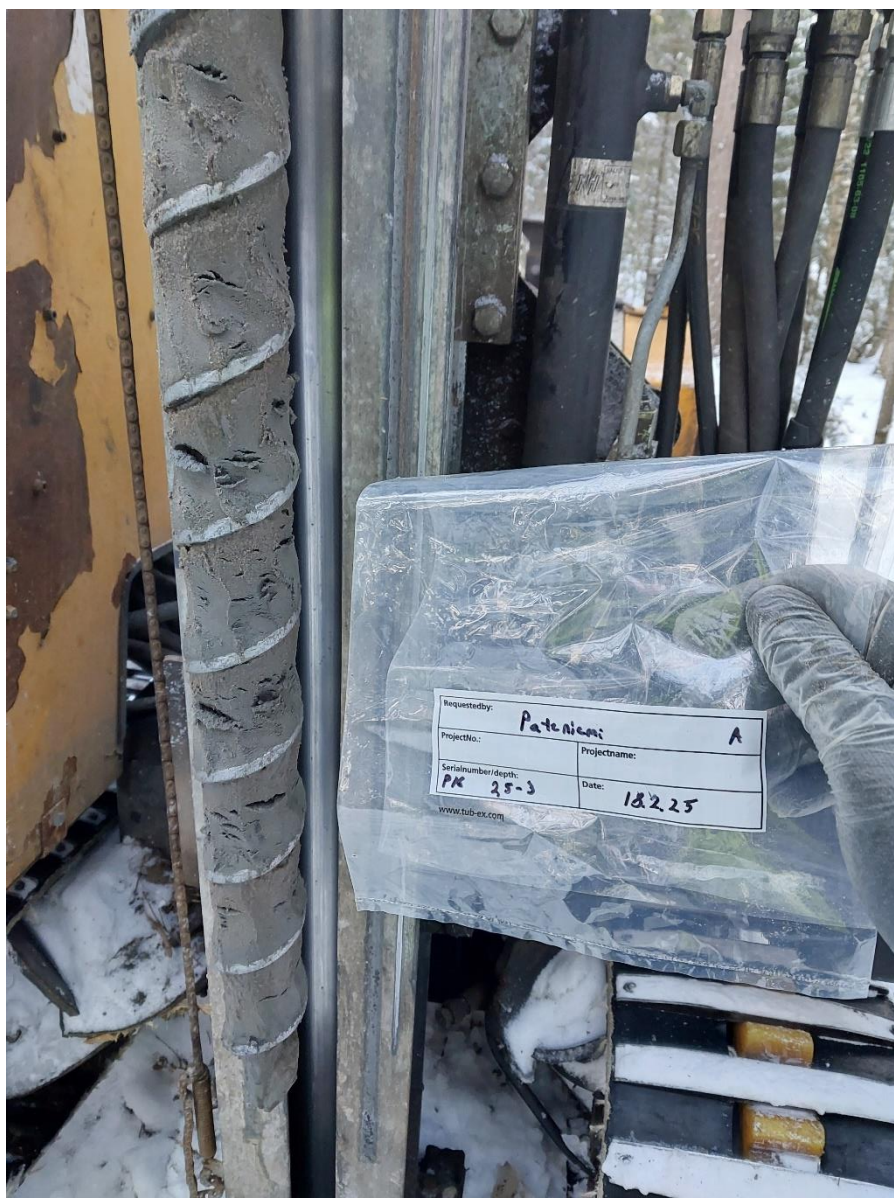
Kuva 2. Näyte "P16 2,5-3 m", jossa todettiin kokonaisrikkipitoisuuden, hapontuottopotentiaalin ja hapetetun pH:n perusteella potentiaalisesti hapanta sulfaattimaata ja tutkimuksen suurin hapontuottopotentiaali.
