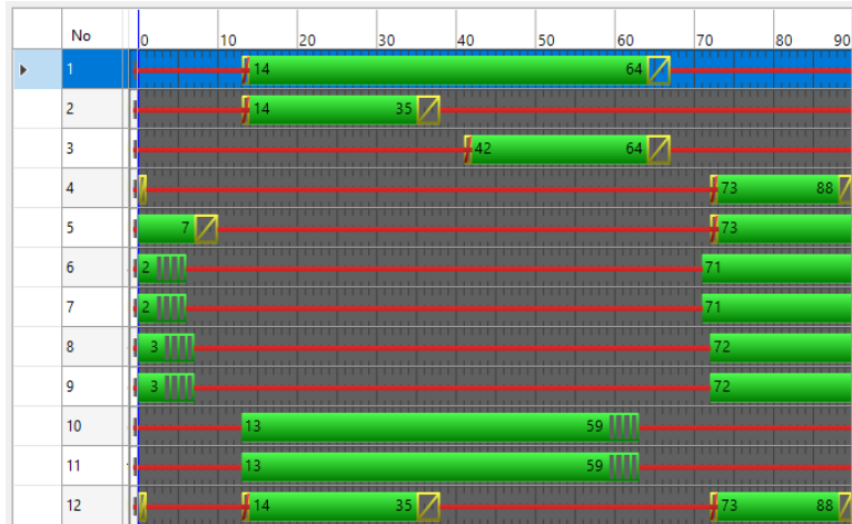
Kuva 10. Iltahuipputunnin liikennevalo-ohjaus nykyverkon tarkastelussa, kun Kotkantie 3:een toteutettu 500 pysäköintipaikkaa.
