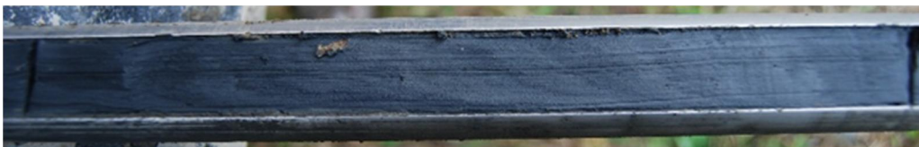
Kuva 5-1 Hapettumatonta, mustaa hienojakoista sulfidisedimenttiä, joka melkein aina happamoituu hapettuessaan. GTK.
