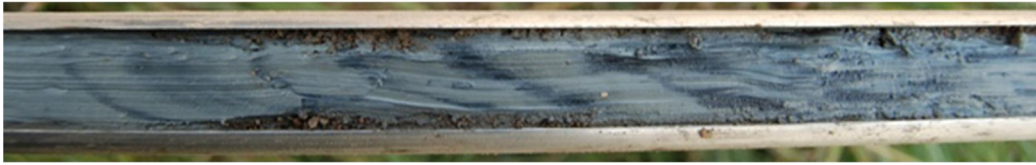
Kuva 5-3. Savea, jossa on mustia monosulfidiraitoja. Tämän näköinen materiaali voidaan usein luokitella happamaksi sulfaattimaamateriaaliksi. GTK.
