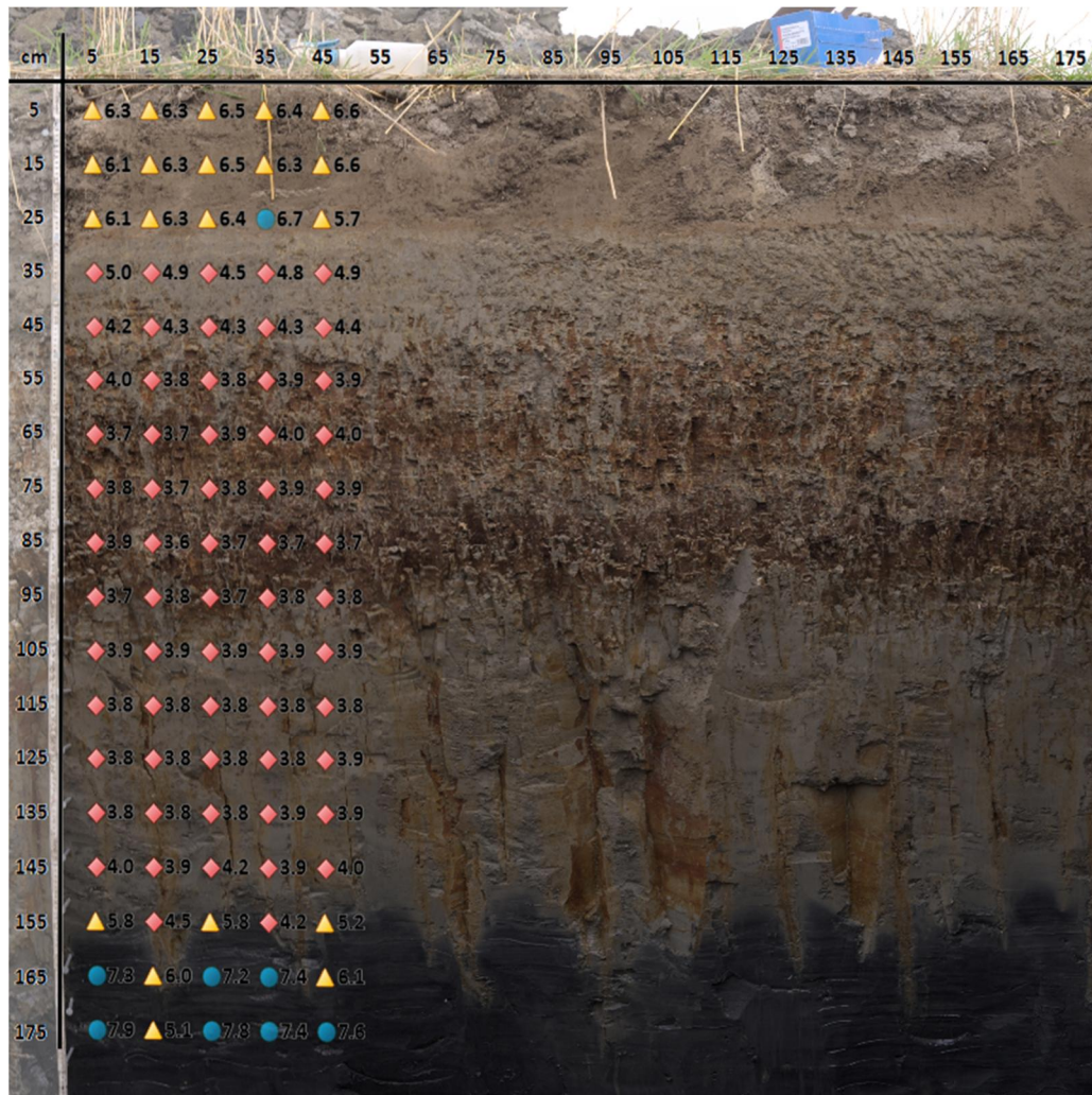
Kuva 5-4. Ote raportista Ramboll 2021. Tyypillinen hienorakeinen (liejusavi) hapen sulfaattimaaprofiili Pohjanmaalla.
