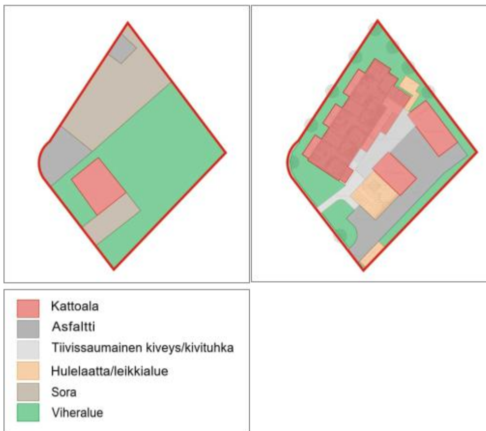
Kuva 6. Ote Hulevesiselvityksestä. Pintojen vertailu nykytilanteen (vasen kuva) ja kaavamutoksessa haetun rakentamisen jälkeen (oikea kuva).
