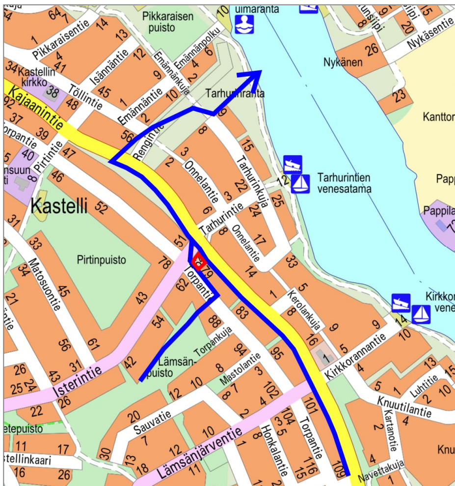
Kuva 7. Tulvatilanteessa syntyvien hulevesien virtausreitti selvitysalueen vierestä kohti Oulujokea (Oulun kaupunki, muokannut Joonas Arstio)
