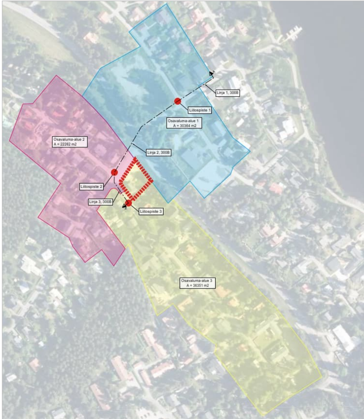
Kuva 13. Selvitysalueen hulevesiviemäriin kapasiteetin arvioimisessa käytetyt osavaluma-alueet sekä liitospisteet.
