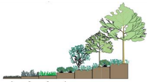
Kuva 6. Vihertyyppien 1-4 kasvualustapaksuudet: 1. maksurohokatto 60...80 mm 2. niitty/ketokatto 150...200 mm 3. heinäkatto 200...300 mm 4. kattopuutarha 200...1000 mm kasvialajikohtaisten vaatimusten mukaan RT 103006 OHJEKORTTI marraskuu 2018
