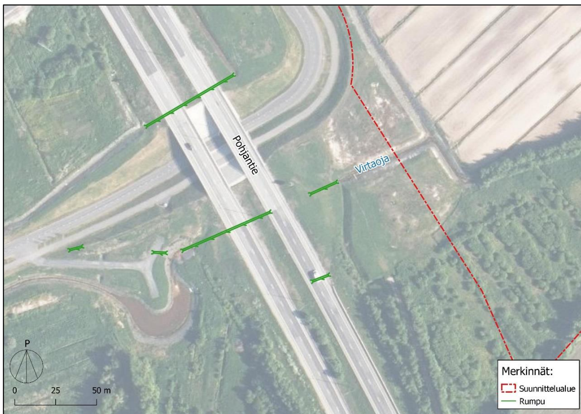
Kuva 10. Pohjantien alittavat rummut eivät ole ajantasaiset verkostotiedoissa. Verkostotiedoissa rumpu ei jatku yhtenäisenä Pohjantien ali (rumputiedot: Oulun kaupunki, Trimble Locus Cloud, ilmakuva: MML).
