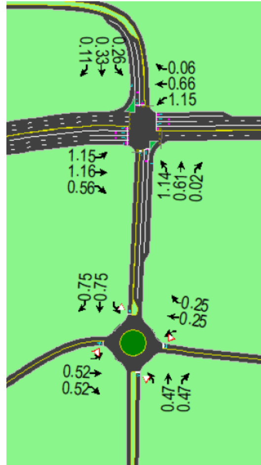
Kuva 12. Metsokankaantien ja Kaakkurinojantien liittymän kunkin kääntymissuunnan kuormitusasteet parannellulla liikennevalo-ohjauksella vuoden 2040 huipputuntiliikennemäärillä. (Solutra Oy 2026)
