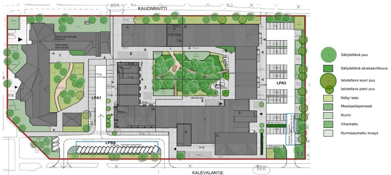
Kuva 16. Vihertehokkuuden laskennassa käytetty pihasuunnitelma (ARCO Architecture Company 2025).
