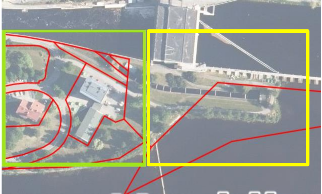
Kuva 8 Toivoniemen itäpuolinen alue. Keltaisella rajatulta alueelta on olemassa olevaa pohjatutkimustietoja. Vihreällä rajattu alue, josta maaperän ominaisuudet eivät ole tiedossa ja jossa suotautumista voi myös tapahtua. Alueella on kerrostaloja ja infrarakenteita. (Pohjakartta: Paikkatietoikkuna, 2025)
