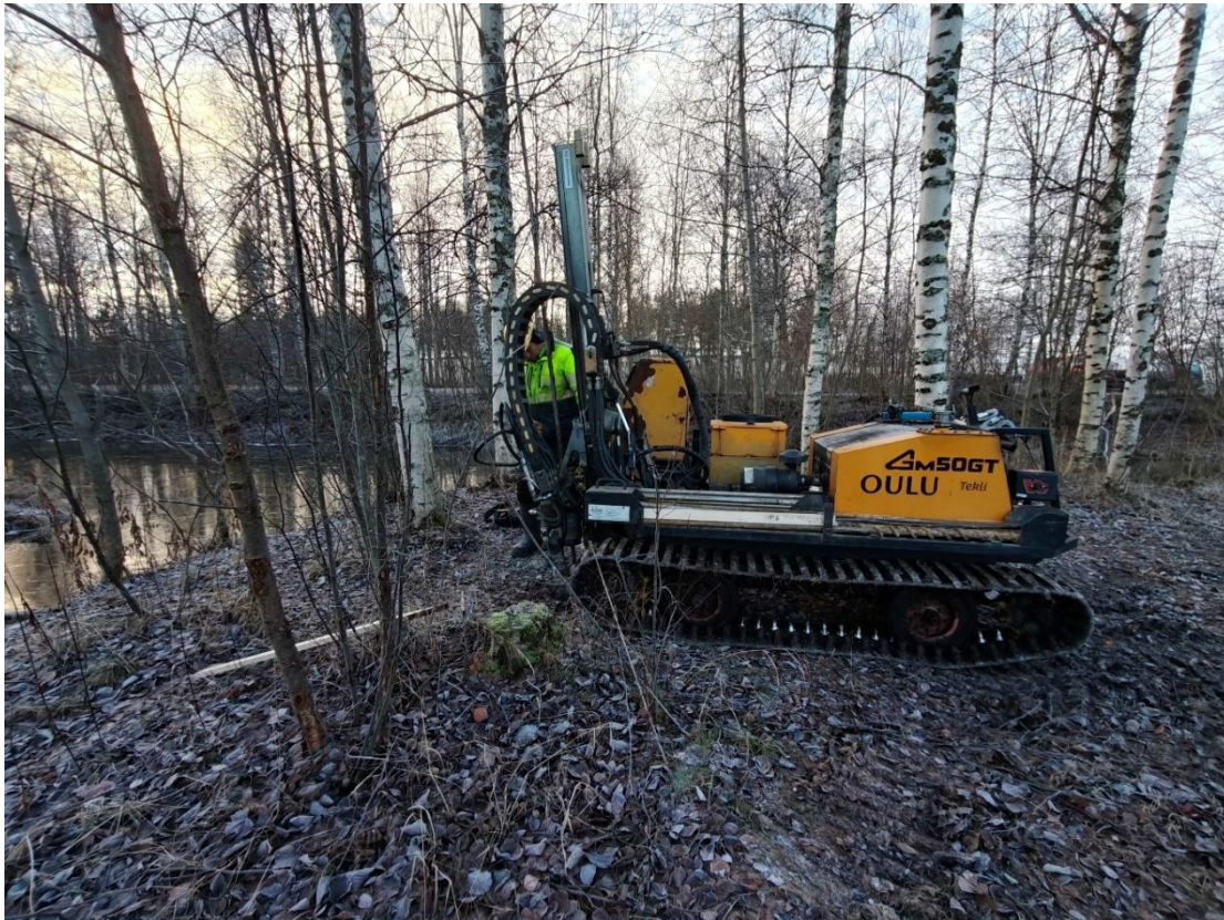
Kuva 1. Kairauskalusto tutkimuspisteellä FCG9.
