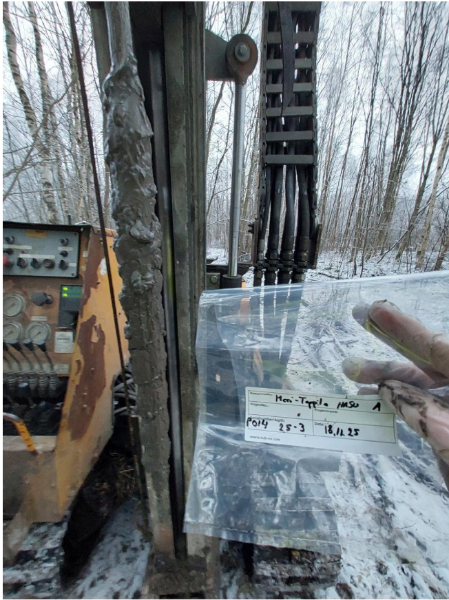
Kuva 3. Näyte P014 (2,5-3 m), jonka kokonaisrikkipitoisuus on alle luokittelurajan. Näyte luokituu kuitenkin pseudo-happamaksi sulfaattimaaksi TPA pH-arvon perusteella ja näytteen hapontuottopotentiaali on suuri.
