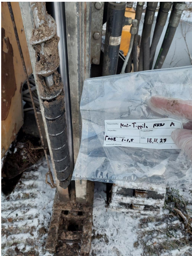
Kuva 2. Näyte P008 (1-1,5 m), joka luokitellaan potentiaalisesti happamaksi sulfaattimaaksi kokonaisrikkipitoisuuden ja TPA pH-arvon perusteella. Hapontuottopotentiaali on suuri.
