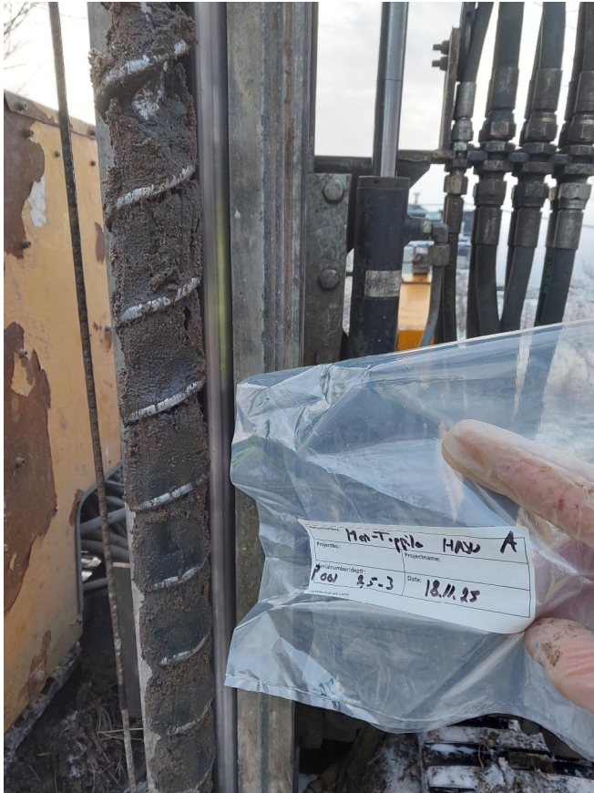
Kuva 1. Näyte P001 (2,5-3 m), joka luokituu rikkipitoisuuden perusteella potentiaalisesti happamaksi sulfaattimaaksi. TPA pH-arvo ei laskenut alle luokittelurajan, mutta hapontuottopotentiaali on silti suuri.
