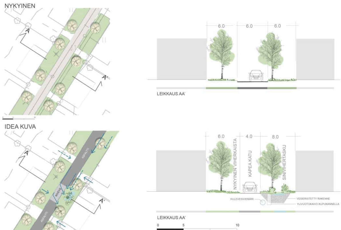
Kuva 6. Esimerkkikuva biosuodatusrakenteiden sijoittelusta.
