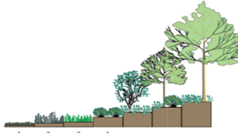
Kuva 6. Viherkattotyypin 1-4 kasvualustapaksuudet: 1. maksaruohokatto 60...80 mm 2. niitty/ketokatto 150...200 mm 3. heinäkatto 200...300 mm 4. kattopuutarha 200...1000 mm kasvialijakoisten vaatimusten mukaan
