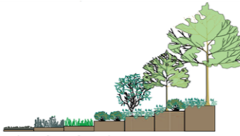
Kuva 6. Viherkattotyypin 1-4 kasvualustapaksuudet: 1. maksaruohokatto 60...80 mm 2. niitty/ketokatto 150...200 mm 3. heinäkatto 200...300 mm 4. kattopuutarha 200...1000 mm kasvilajikohtaisten vaatimusten mukaan
