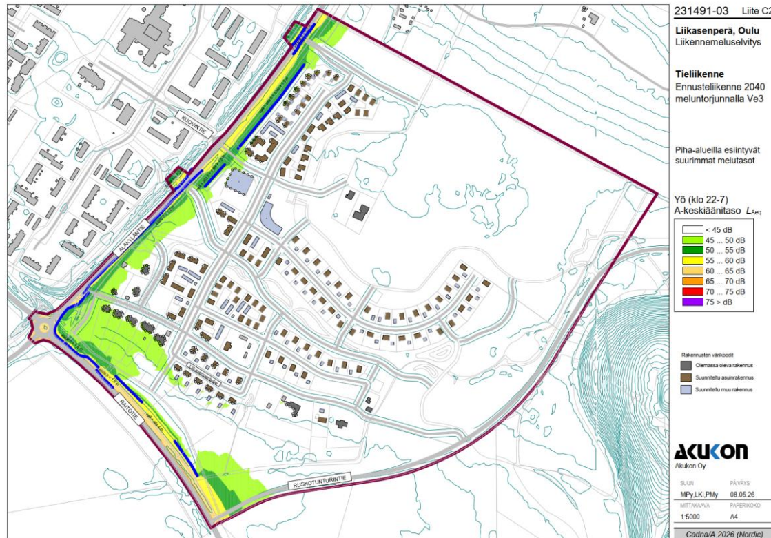
Kuvat 31. ja 32. Vasemman puoleinen kuvaote melunleviämislaskennasta meluntorjuntavaihtoehdolla 3 yöaikaan. Oikean puoleinen kuvaote melunleviämislaskennasta meluntorjuntavaihtoehdolla 4 yöaikaan. Vaihtoehtoissa on optimoitu meluntorjuntaratkaisujen sijaintia sekä korkeutta.
