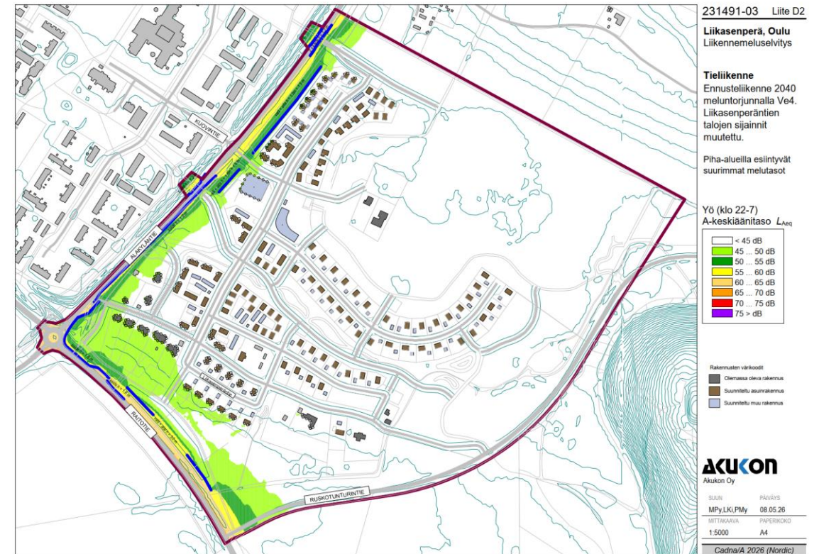
Kuvat 31. ja 32. Vasemman puoleinen kuvaote melunleviämislaskennasta meluntorjuntavaihtoehdolla 3 yöaikaan. Oikean puoleinen kuvaote melunleviämislaskennasta meluntorjuntavaihtoehdolla 4 yöaikaan. Vaihtoehtoissa on optimoitu meluntorjuntaratkaisujen sijaintia sekä korkeutta.
