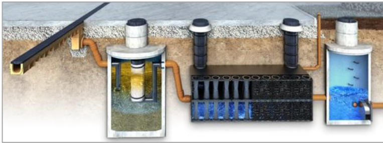
Kuva 17. Hulevesikasettijärjestelmä hulevesien imeytykseen/viivytykseen (ACO Nordic Oy) kuvassa vasemmalta – oikealle: linjakaivo – erotuskaivo – viivytyksasetti – virtauksensääntökaivo.
