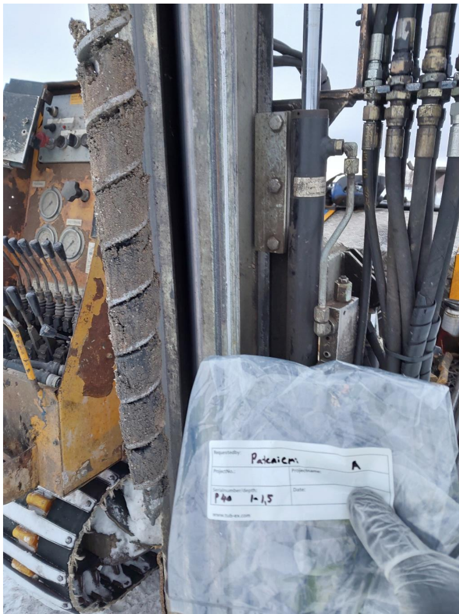
Kuva 6. Näyte "P40 1-1,5 m", jossa todettiin hapontuottopotentialin ja hapetetun pH:n perusteella potentiaalisesti hapanta sulfaattimaata.
