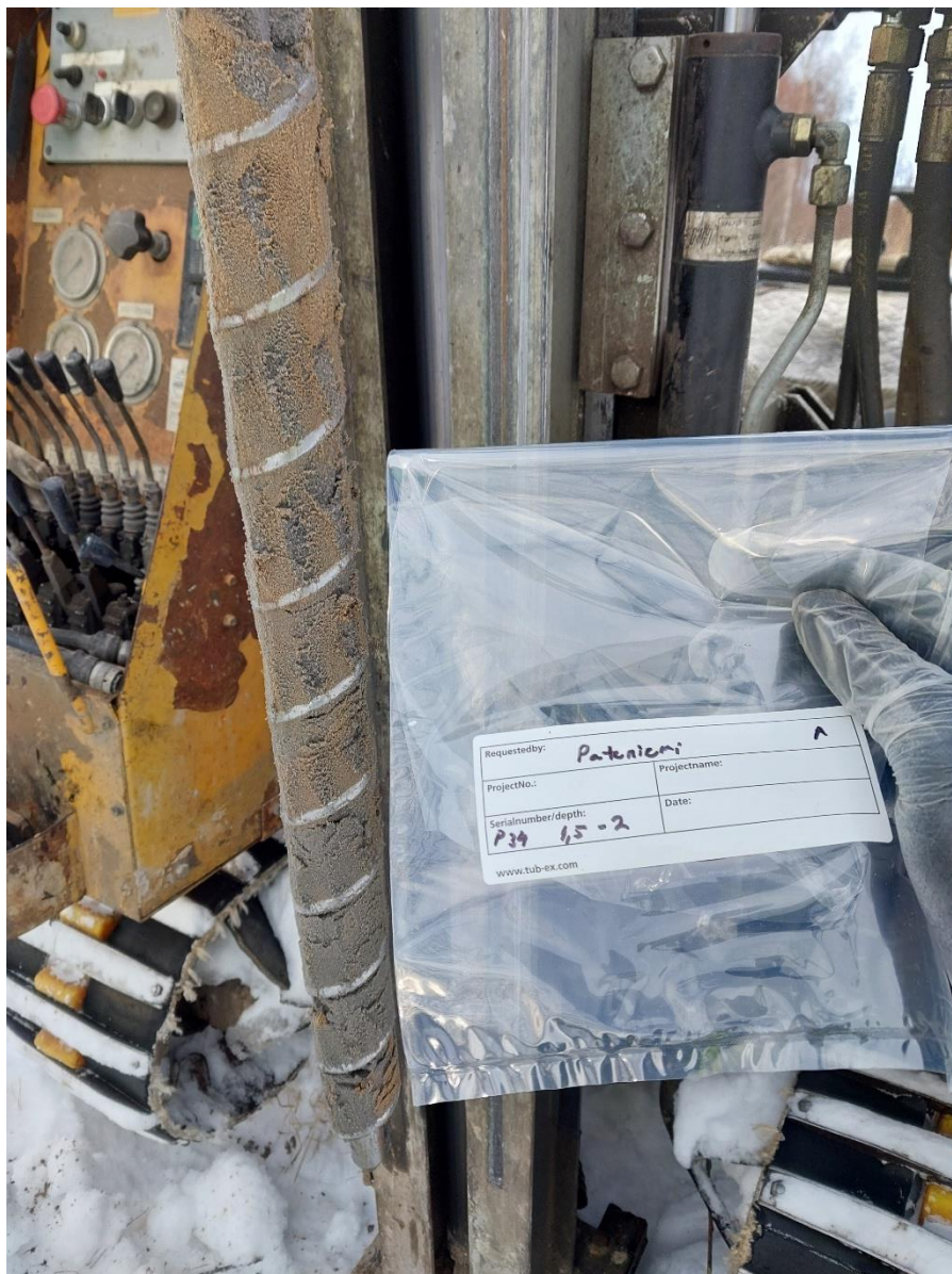
Kuva 5. Näyte "P34 1,5-2 m", jossa todettiin hapontuottopotentialin ja hapetetun pH:n perusteella potentiaalisesti hapanta sulfaattimaata.
