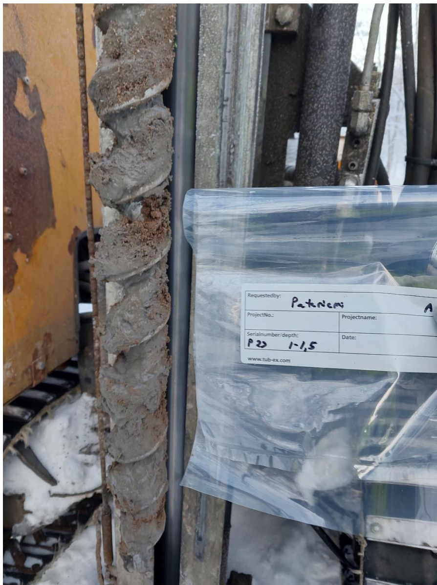
Kuva 4. Näyte "P29 1-1,5 m", jossa todettiin hapontuottopotentialin ja hapetetun pH:n perusteella hapanta sulfaattimaata.
