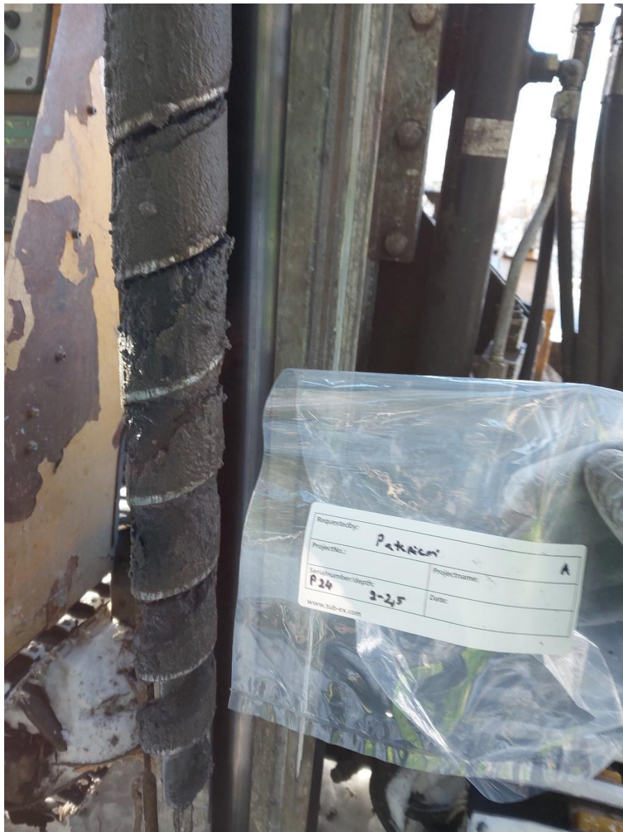
Kuva 3. Näyte "P24 2-2,25 m), jossa todettiin kokonaisrikkipitoisuuden, hapontuottopotentiaalin ja hapetetun pH:n perusteella potentiaalisesti hapanta sulfaattimaata.
