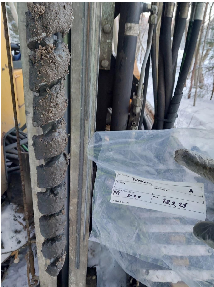
Kuva 1. Näyte "P13 2-2,5 m", jossa todettiin hapontuottopotentiaalin ja hapetetun pH:n perusteella potentiaalisesti hapanta sulfaattimaata.
