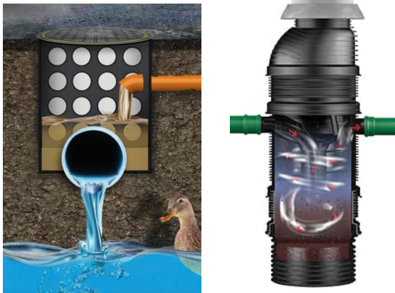
Kuva 16. Smart Trap –hulevesikaivo vasemmalla ja EuroHEK Filter –kiintoaine-erotin oikealla ( www.uponor.fi ja www.wavin.com ).
