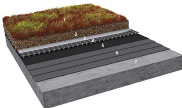
Kuva 5. Viherkaton rakenteet. Lähde: Leca Finland Oy.
