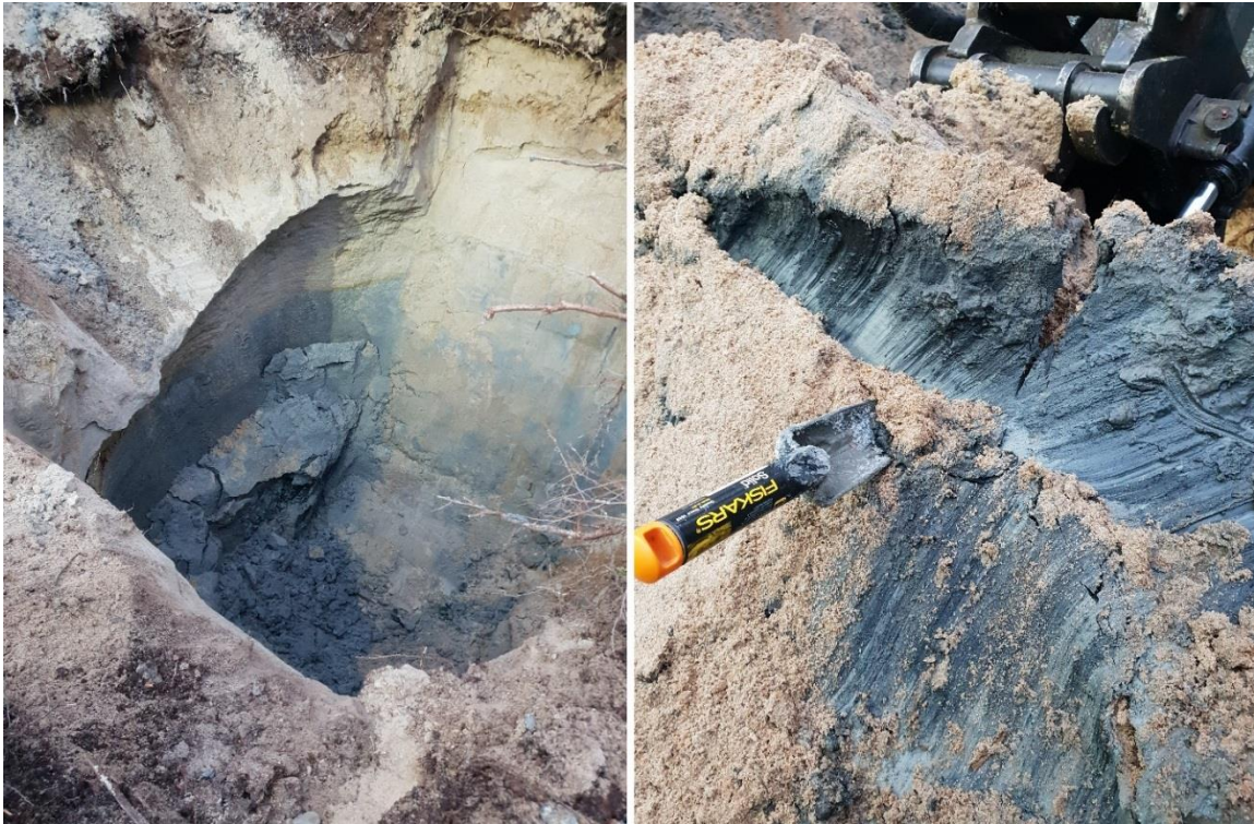
Kuva 3-1. Valokuvia koekuopasta KK4. Hienojakoisen maa-aineksen tummat juovat viittaavat rikkiyhdisteiden olemassa oloon.
