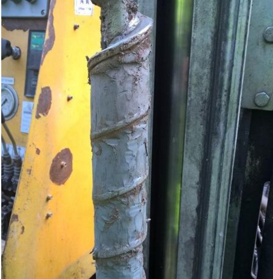
Kuva 4. Näytteenottopisteen P1 näyte 1,0 – 1,5 m syvyydestä. Maalaji on laihaa savea, jonka seassa on ruostetta.
