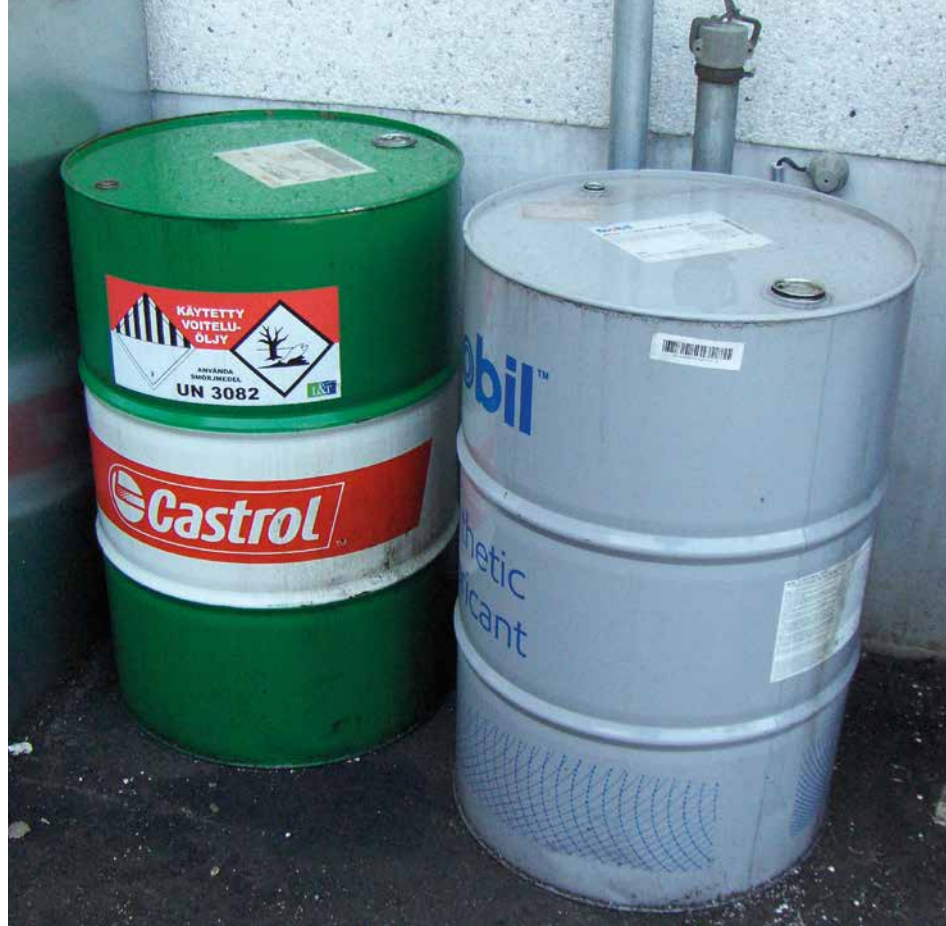
Kuva 6. Jäteöljytynnyreitä ulkona ilman valuma-allasta.
