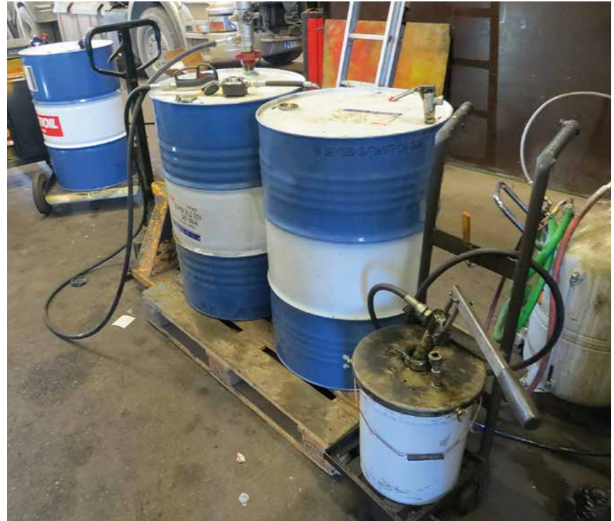
Kuva 9. Kemikaalien varastointia ilman valuma-allasta.
